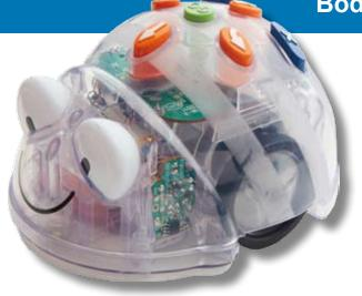
Der Blue-Bot ist ein fernsteuerbarer Bodenroboter. Die Schüler legen die Programmschritte auf einem Tablet fest und senden sie per Bluetooth-Verbindung an den Roboter. Dieser führt dann die Schritte aus.
